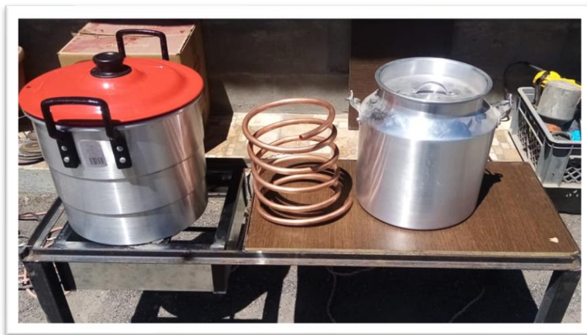
Ilustración 1. Partes de alambique CASERO Autor: Gloria Pinta Remache
