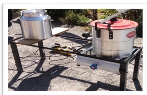
Ilustración 3 armado de olla enfriadora / caldero Autor: Gloria Pinta Remache
